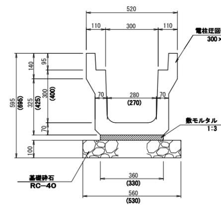
電柱迂回側溝用蓋 S=1:10
